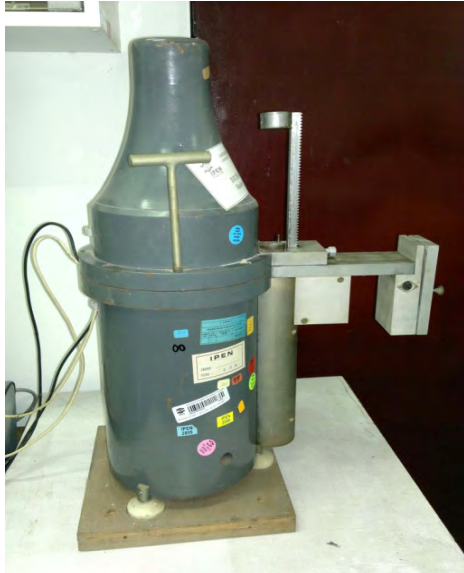
Figura 2. Primer plano cabezal de detección conteniendo los dos detectores de centelleo plástico acoplados a tubos fotomultiplicadores y preamplificadores.
