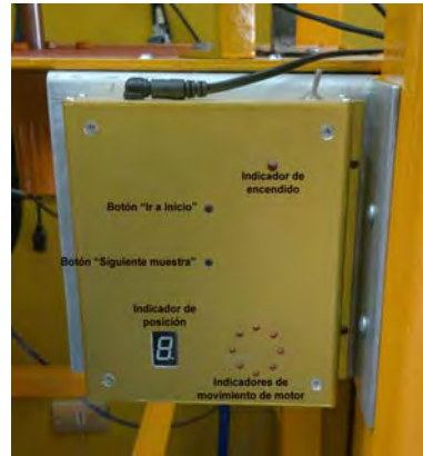
Figura 4. Imagen que muestra el panel frontal del módulo de control electrónico y comunicación.
