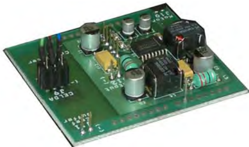
Figura 4. Convertidor DC-DC montado sobre tarjeta tipo "shield" que es insertada sobre la tarjeta del potencióstato.
