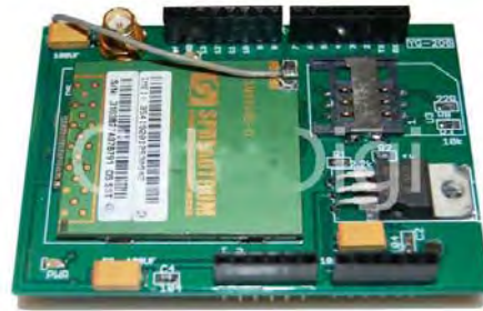
Figura 2. "Shield" para plataforma Arduino con módulo SM5100B utilizado.
