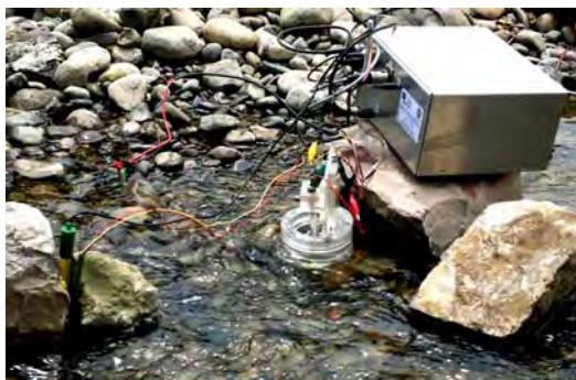
Figura 7. Medidor autónomo trabajando en condiciones de campo en un puquial del río Lurín.
