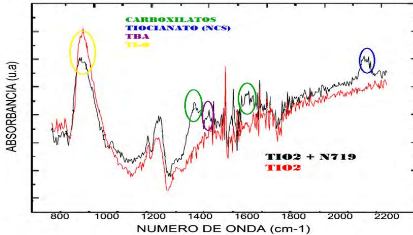
Figura 15. Espectro de absorción FTIR de la película de TiO<sub>2</sub> sin colorear y coloreada.
