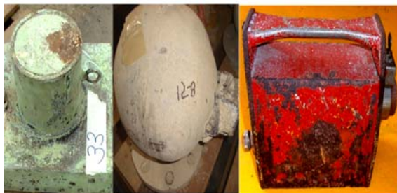
Figura 1. Fuentes radiactivas recolectadas que no presentaban placa de identificación cuando fueron recolectadas.
