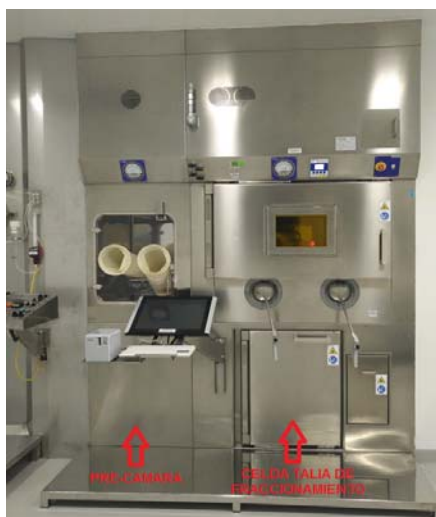
Figura 1. Ubicación de la precámara en conjunto con la celda Talia de fraccionamiento.
