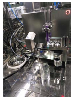
Figura 3. Cámara principal de la celda Talia de fraccionamiento.
