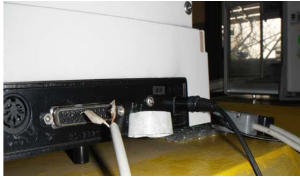
Fotografía 1. Puerto Serial RS-232 de la balanza (Sensor)
