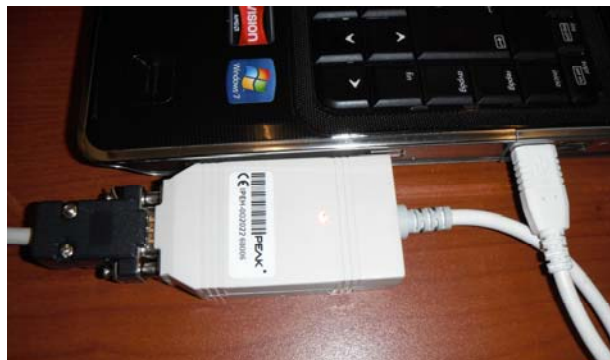
Fotografía 3. Adaptador de PC USB a bus CAN
