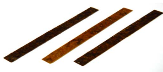
Figura 3. Probetas preparadas para pruebas mecánicas.
