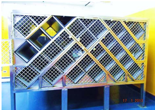
Figura 1. Armario de EECC no irradiados.
