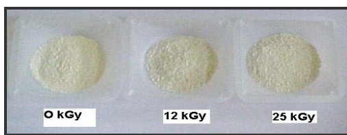
Figura 2. Diferencia de color entre muestras de concha de nácar en polvo irradiadas a 0, 12 y 25 kGy.
