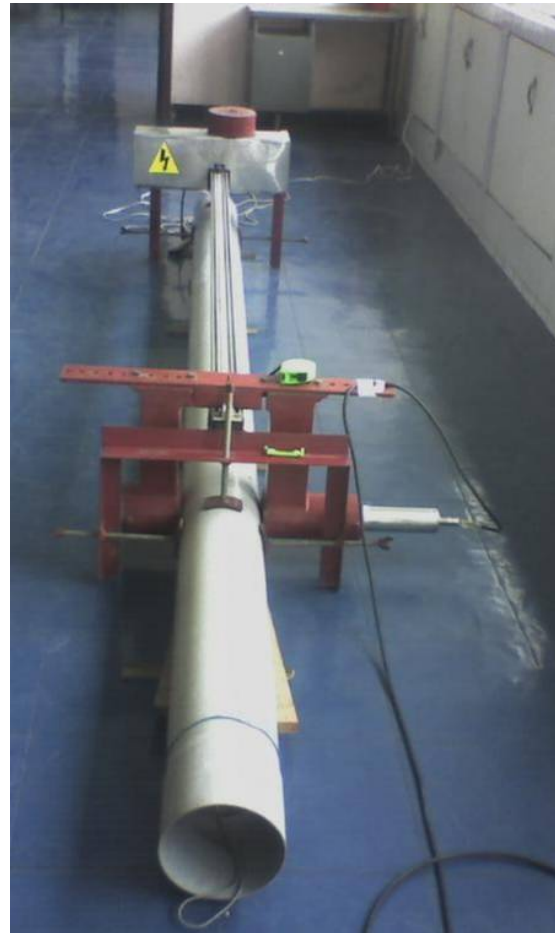
Figura 3. Columna evaluada con perfilaje gamma.
