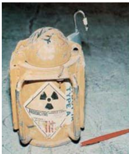
Figura 2. Fuentes radiactivas en desuso.
