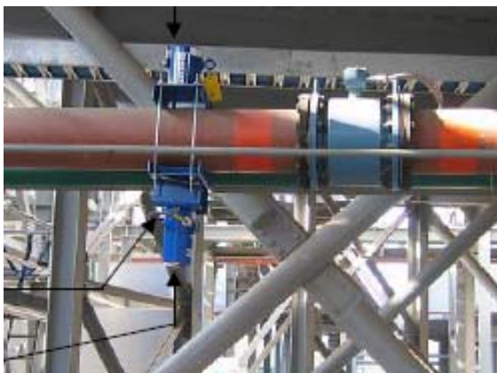
Figura 5. Medidor nuclear ubicado en zona de Concentrado a granel (fuente: Cs-137 de 50 mCi).
