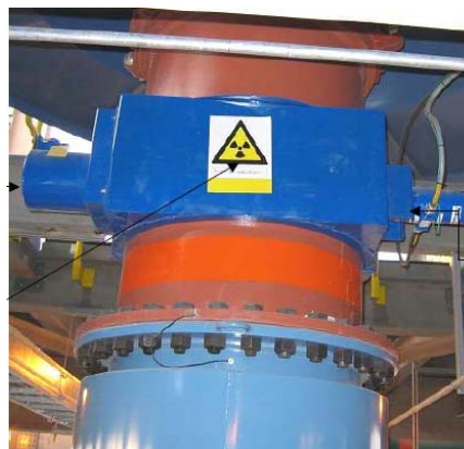
Figura 6. Medidor nuclear en zona de espesamiento de minerales (fuente: Cs-137 de 5000 mCi).
