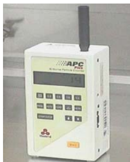
Figura 1. Contador de partículas marca BIOTEST APC Plus.
