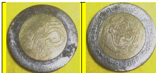
Figura 4. Es visible la oxidación que presenta la superficie de la moneda falsa de 5 Nuevos Soles.
