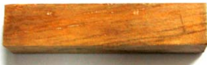
Figura 7. Luego del ataque con hongos, se puede observar que la superficie esta casi intacta, pero con una ligera coloración.
