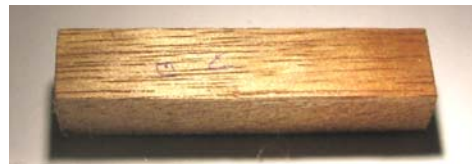
Figura 10. No se observa deterioro superficial. Al lado derecho se observa un cambio en el color.
