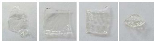
Figura 1. Hidrogeles de Aloe vera - Alcohol polivinílico a las dosis de 8, 11, 15 y 26 kGy.
