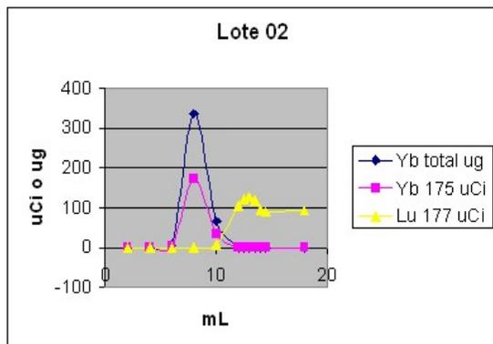
**Figura 1.** Lotes 1 y 2: Elución con HCl 1,5 M. Masa de Yb<sub>2</sub>O<sub>3</sub>: 2 mg.
