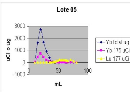
**Figura 2.** Elución con HCl 1 M. Masa de Yb<sub>2</sub>O<sub>3</sub>: 2 mg (lote 3) y 12 mg (lotes 4 y 5).
