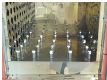
Figura 2. Disposición de los indicadores biológicos dentro de la estufa sin carga de trabajo.
