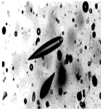
Figura 1. Huellas alfa registradas por detectores plásticos (cortesía, www.erilresearch.com/ ).
