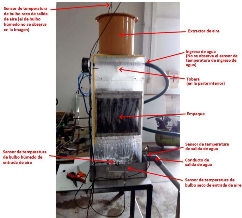
Figura 4. Prototipo de torre de enfriamiento ensamblada.
