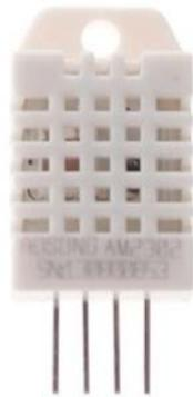
Figura 6. Sensor DHT22
