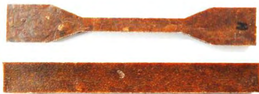
Figura 6. Probetas para ensayos mecánicos
