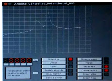
**Figura 3.** Captura de pantalla de la interfaz desarrollada para controlar el módulo del potenciostato.
