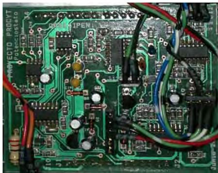
**Figura 1.** Primer plano de la tarjeta analógica del potenciostato para ser montada como *shield* sobre una tarjeta Arduino Duemilanove.
