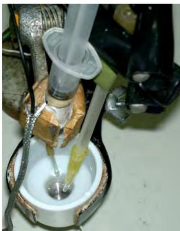
**Figura 2.** Celda electroquímica construida para realizar las pruebas de medición del potenciostato.
